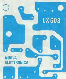
Fig. 3 Disegno a grandezza naturale del circuito stampato.
